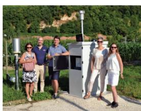
Sistemi di allerta pollini più efficaci e tempestivi, riconoscimento di spore fungine dannose per le colture e monitoraggio del particolato inquinante: grazie allo strumento "Rapid-E", sviluppato da uno spin-off dell'Università di Ginevra e installato per la prima volta in Italia negli spazi della Fondazione Edmund Mach, i ricercatori potranno disporre in tempo reale di informazioni accurate su numerosi componenti aerodispersi.
